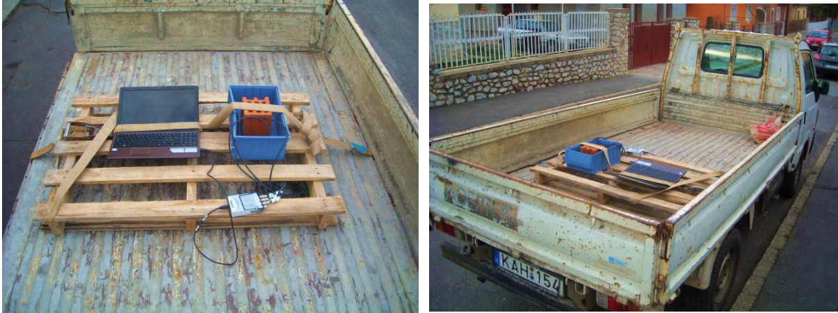
12. ábra. Rezgésmérés fényképfelvétel, teherautós szállítás
