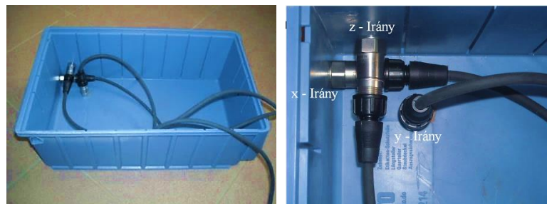
5.9. ábra. Egységtrakomány képző a gyorsulásmérő szenzorokkal
