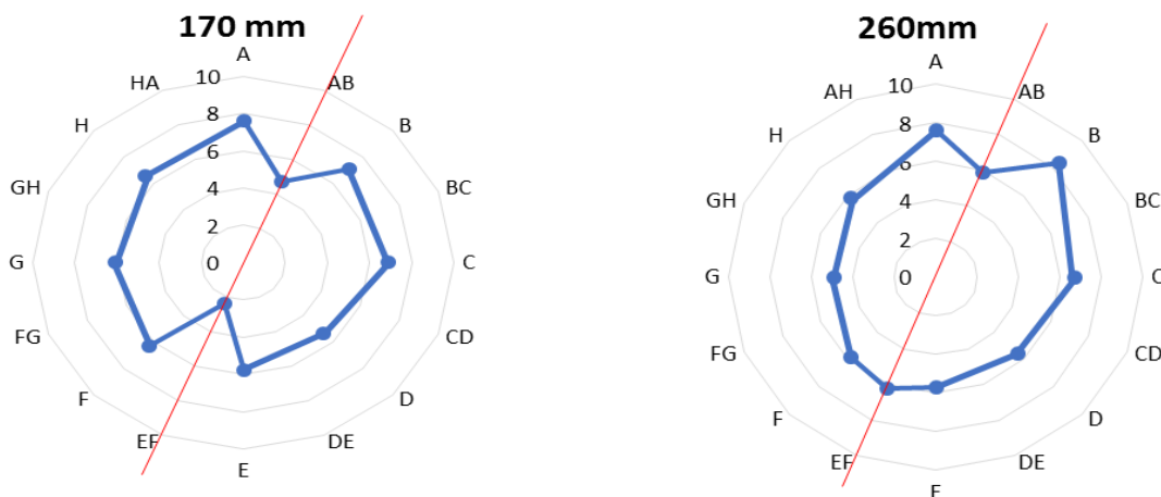
61. ábra A hántolt (2VS) rúd különböző metszetein, a nyolc alkotón mért maradék ausztenit mennyisége. Az elhajlás síkját piros vonal jelzi
