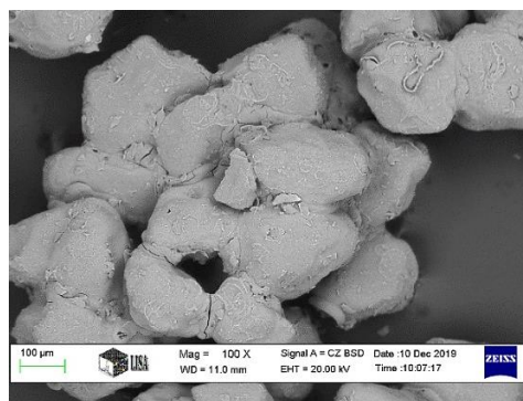
35. ábra A 300°C-on hőterhelt, 5. ciklusból származó hőterhelt vízüveges homokkeverék SEM felvétele
