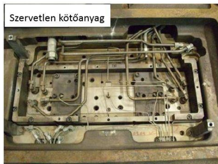
6. ábra A szervetlen kötőanyaggal készült magoknál nincs kondenzátum képződés [20]
