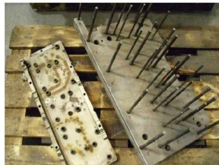
6. ábra A szervetlen kötőanyaggal készült magoknál nincs kondenzátum képződés [20]
