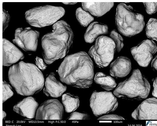
17. ábra Az SH34-es alaphomok pásztázó elektronmikroszkóppal készített felvétele
