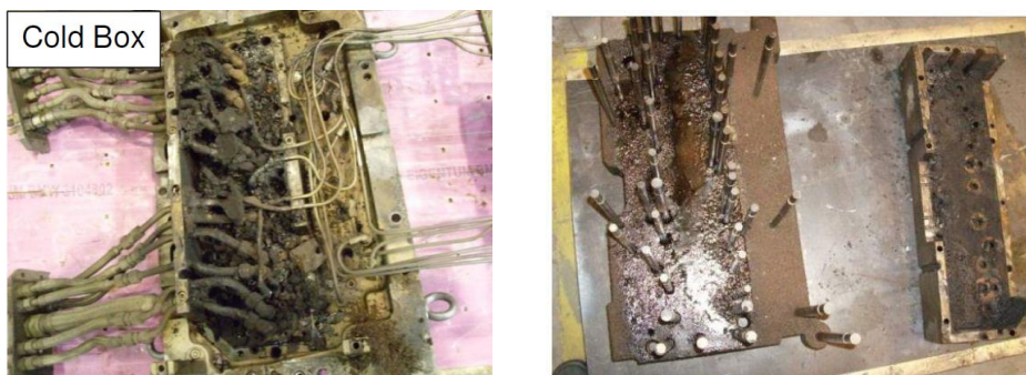
5. ábra A cold-box-eljárás során jelentős mennyiségű kondenzátum képződik, amely erőteljesen szennyezi a kokilla felületét [20]
