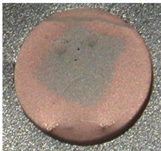
122. ábra Besugárzott felület módosulása a porlasztás után
