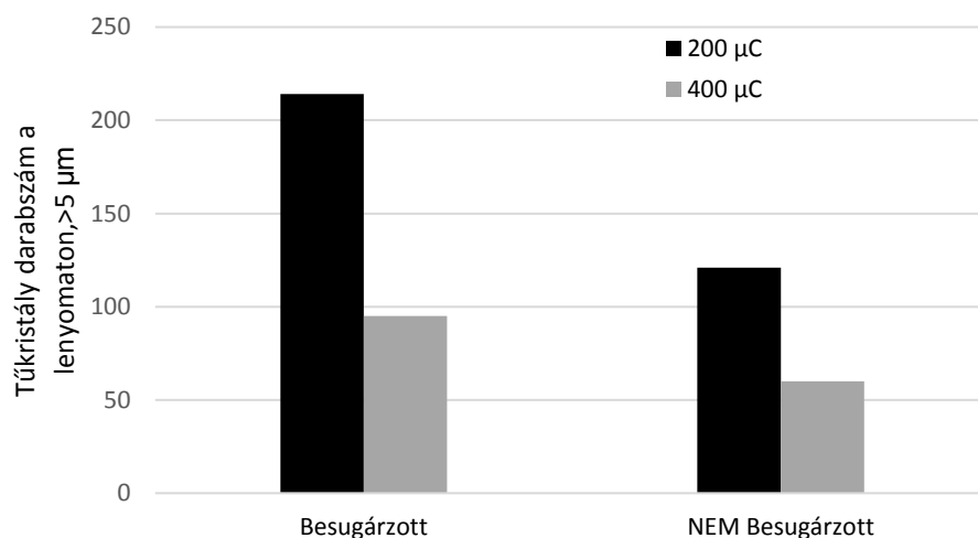
(3T/1. ábra) Tűkristály képződés változása besugárzás hatására
