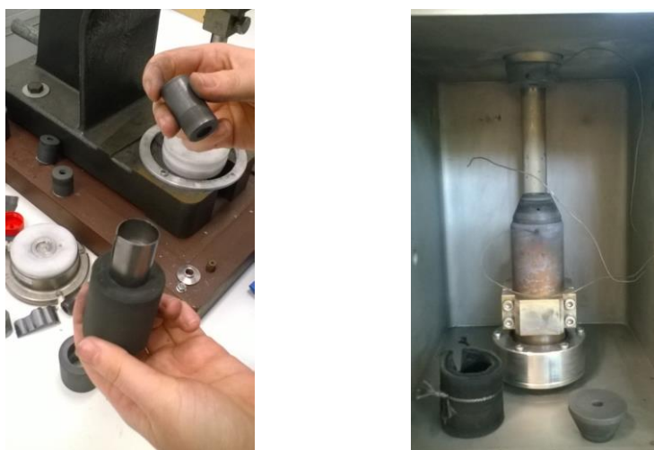
21. ábra. A por kézi tömörítése és a szinterelő kamra szinterelés előtt
