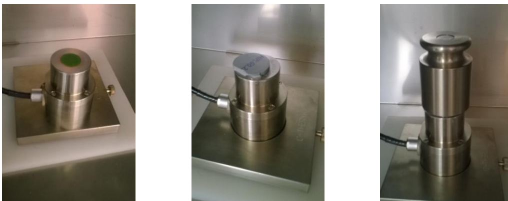
26. ábra. A hővezetési tényező vizsgálat előkészítésének lépései
