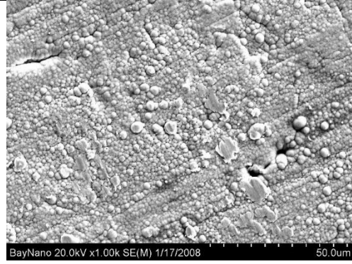
30 min Ni-P leválasztási idő. M= 1000x
