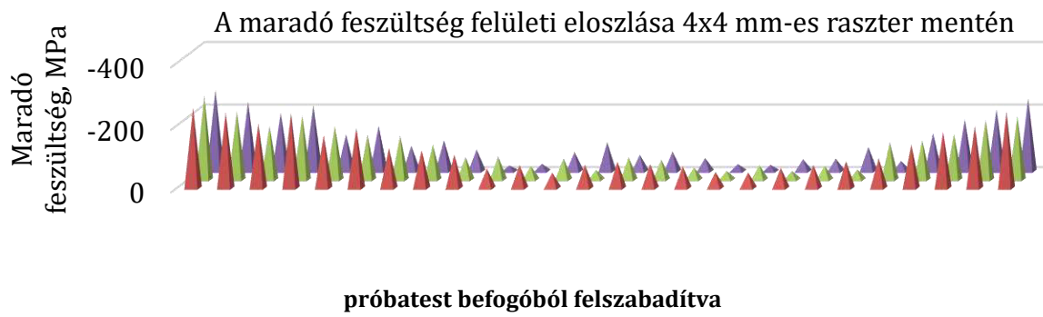
58. ábra 42CrMo4/1 próbatest szemcseszórt felszínén mérhető feszültség eloszlása
