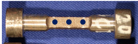
69. ábra A próbatetek egy oldalán rögzített maradó feszültség értékek mérési területei
