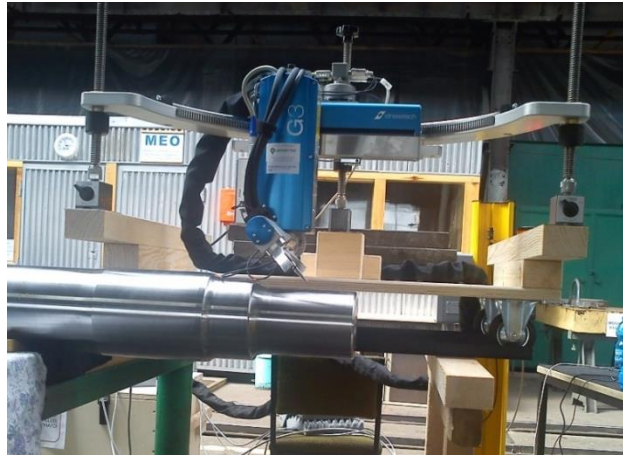
28. ábra A Stresstech G3R berendezés ipari létesítményben történő munkavégzés, állványról történő vasúti tengely mérése közben
