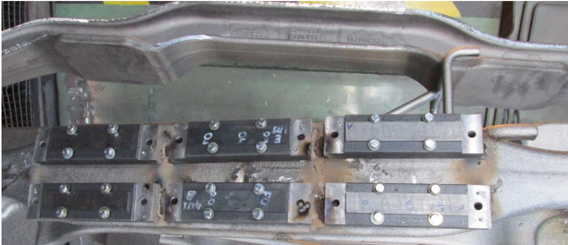
49. ábra Csavarral befogóba rögzített próbatestek, szemcse szórás előtt a merevtengelyre hegesztve.
