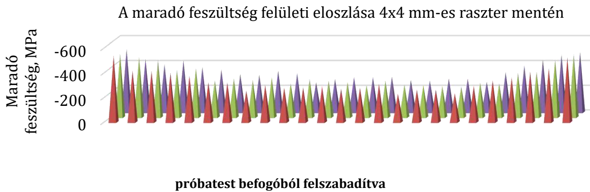
59. ábra MIL-A 46100/1 próbatest szemcseszórt felszínén mérhető feszültség eloszlása
