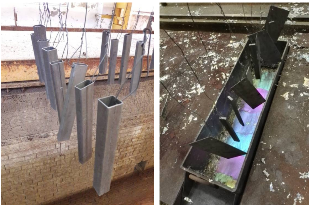
33. ábra: A horganyzásra előkészített darabok szárítás közben és bemártás előtt
