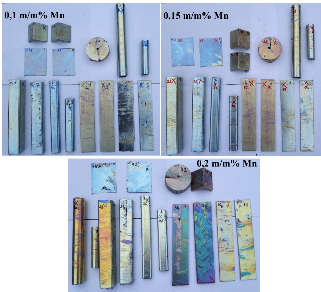
51. ábra: A három különböző mangán koncentráción horganyzott darabok összesítő fotói
