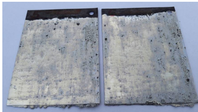
35. ábra: 0,018 m/m% mangán tartalmú, 450°C-os horganyfürdőben előállított – párhuzamos – mintalemezek
