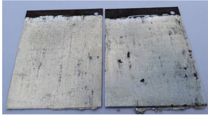
34. ábra: 0,0041 m/m% mangán tartalmú, 450°C-os horganyfürdőben előállított – párhuzamos – mintalemezek
