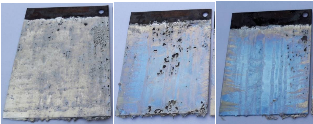
B. ábra: 0,018 – 0,044 – 0,057 m/m% mangán tartalmú horganyfürdőben előállított acéllemezek
