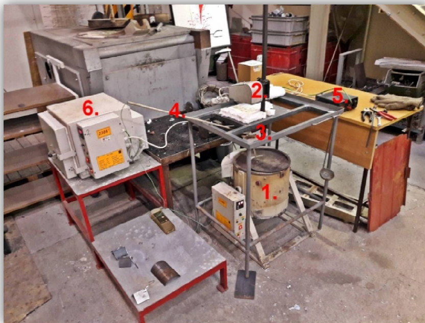
29. ábra: A saját, általam továbbfejlesztett laboratóriumi horganyzó berendezés főbb egységei: 1. Ellenállás fűtésű olvasztókemence, 2. Mozgatószerkezet a minta beengedéséhez és kiemeléséhez, 3. Mintabefogó, 4. Hőelem közvetlenül az olvadékban, 5. Tápegység a mozgatómotorhoz, 6. Ellenállás fűtésű hőkezelő kemence az utólagos hőntartáshoz
