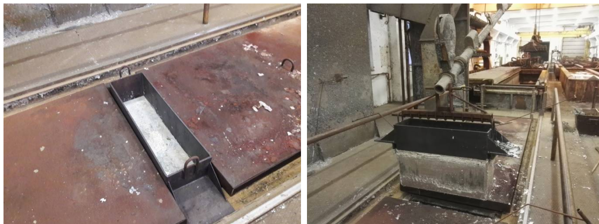
31. ábra: A kísérleti horganyzókád behelyezve a nagy kádba, valamint kiemelve
