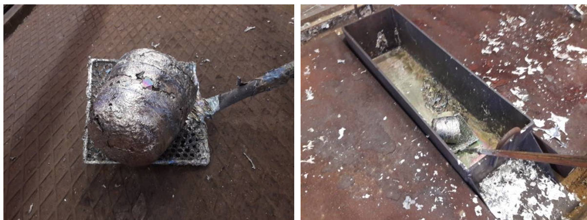
32. ábra: A mangán beötvözése az új ötvözési módszerrel
