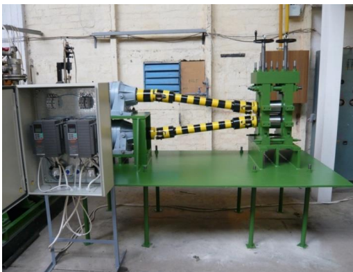
2. ábra STANAT gyártmányú duó hengerállvány (balra), iker motoros hengerállvány (jobbra)
