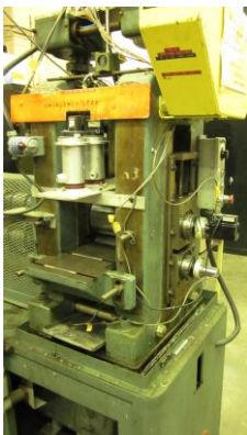
2. ábra STANAT gyártmányú duó hengerállvány (balra), iker motoros hengerállvány (jobbra)
