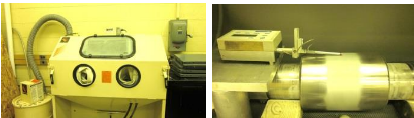
3. ábra A szemcseszóró berendezés (balra), a szemcseszórt hengerfelület és a felületi érdesség mérés (jobbra)
