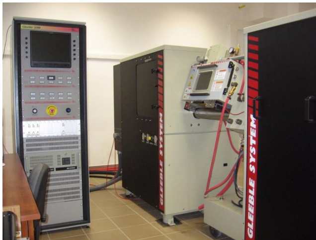
4.1. ábra. A Gleeble 3500 termo-mechanikus fizikai szimulátor a Miskolci Egyetem Anyagszerkeztani és Anyagtechnológiai Intézetében
