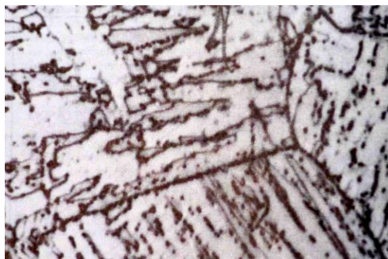
2.6. ábra. Megeresztett tűs martensit a megmaradt tűk határfelületeivel ( N=2000\times , C=0,18\% , T_{meg} = 600\text{ }^{\circ}\text{C} , t_{meg}=10\text{ min} ) [27]
