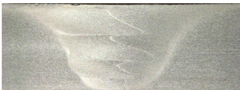
4.7. ábra. A „lazy S” eltérés az 5754-H22 alapanyagból készült hegesztett kötésben (1,25x nagyítás)
