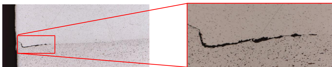
5. ábra - Az alakítás hatására nem megfelelően összehegedt felületek a darab szélén
