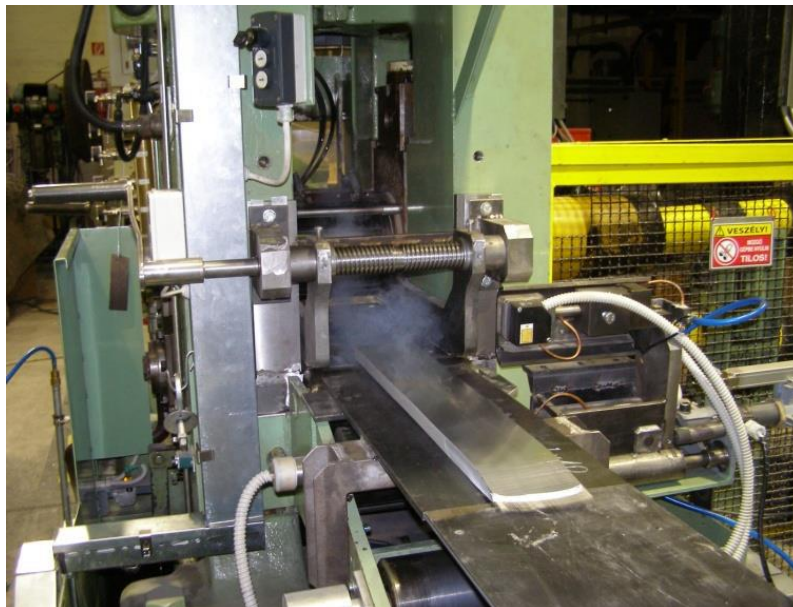
2. ábra - A Von-Roll gyártmányú hengerállvány meleghengerlés közben
