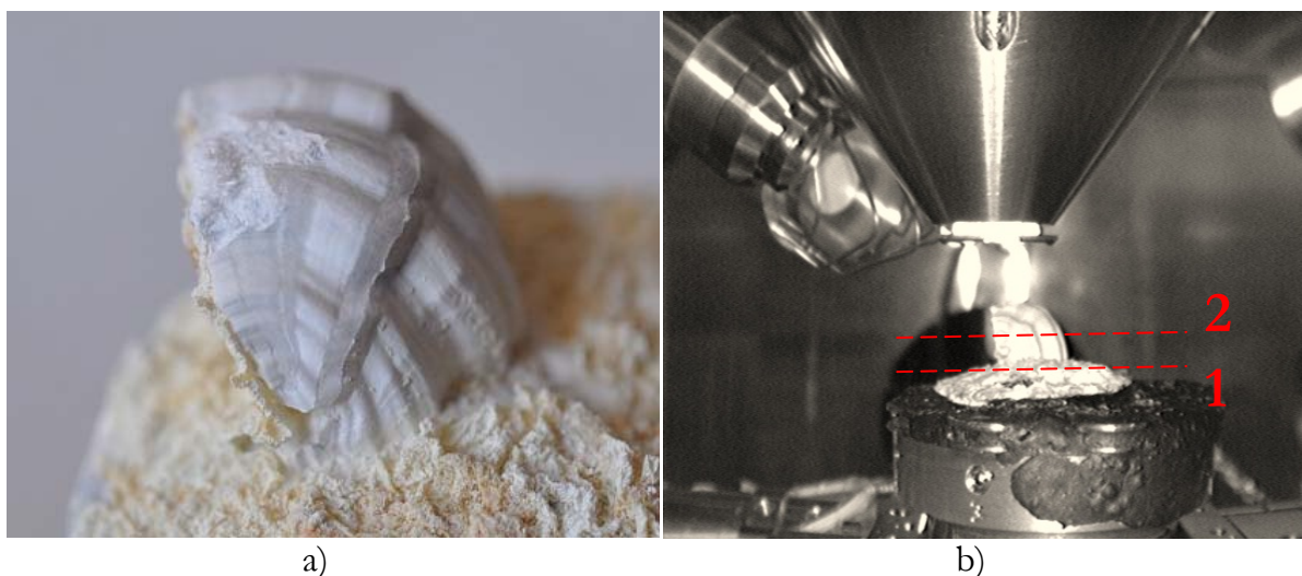
18. ábra Sn-Ag alapú whisker – a) makro fotóval dokumentálva – b) az elektronmikroszkóp kamrájában, megjelölve a későbbi csiszolatkészítési helyeket
