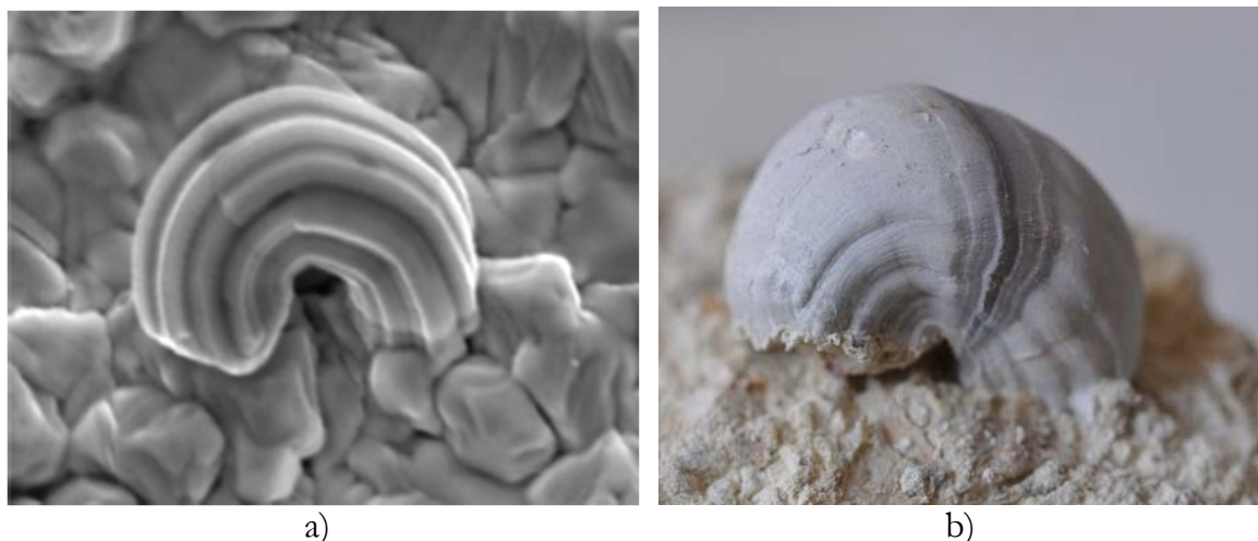
17. ábra Csomó alakú whiskerek – a) \sim 17 \mu\text{m} hosszú ón whisker (Nakadaira és társai, 2007) b) \sim 2 \text{ cm} hosszú ón-ezüst whisker (saját kísérlet)
