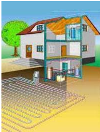
6. ábra: Talaj kollektoros rendszer elve [6]
