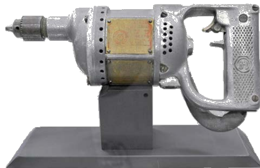
1.2. ábra: Black&Decker első pisztoly típusú fúrógépe [6]
