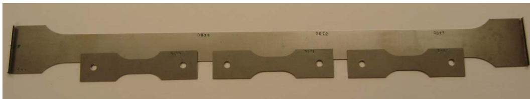
4.10. ábra. Előalakított próbatest és az abból ciklikus vizsgálatra kimunkált próbatestek
