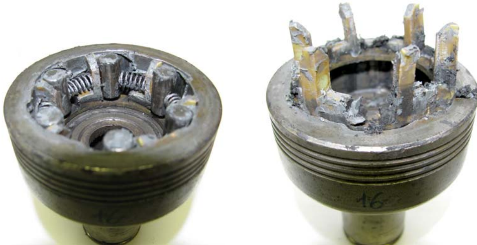
8.7. ábra Szétszerelt szabadonfutó
