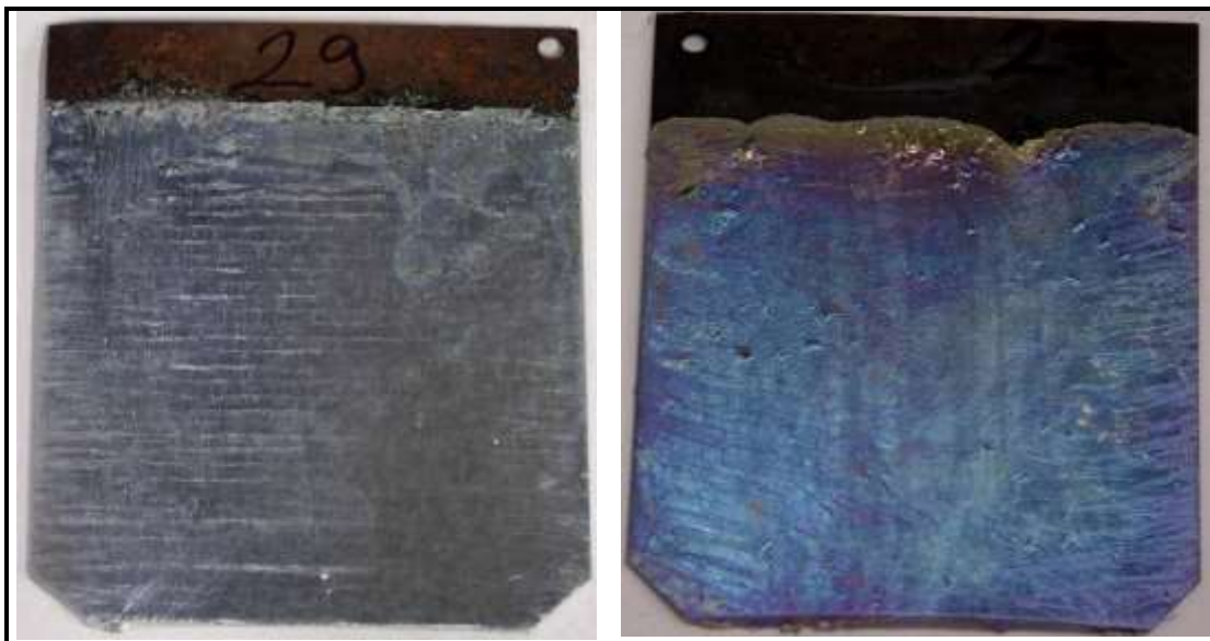
28. ábra: A terelőlemezzel előállított, salak és oxidfelrakódás nélküli, megfelelő területű lemez minta normál horganyfürdőben (balra), valamint titánnal ötvözött fürdőben (jobbra)
