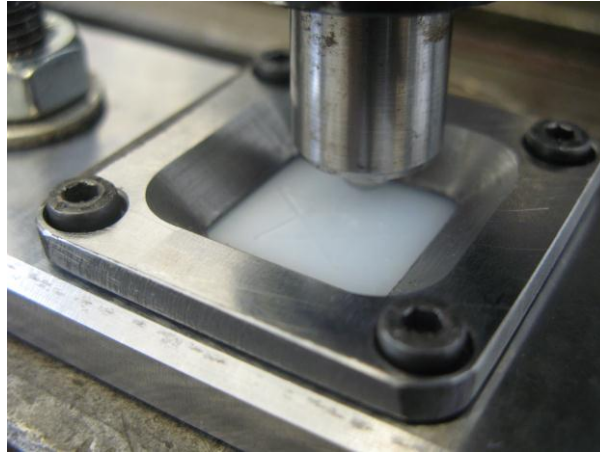
66. ábra. UHMWPE minta a kereszt-nyírásos koptatás közben
