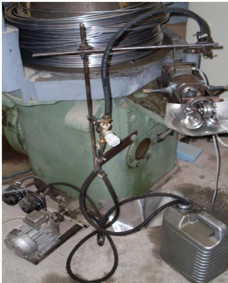
24. ábra. A szűrővel ellátott folyamatos kenést biztosító szivattyúrendszer.
