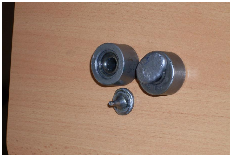
28. ábra. Húzószerszámok üregeibe öntött ólomdarabok, melyekkel a kúpszögek nagyságát állapítottam meg.
