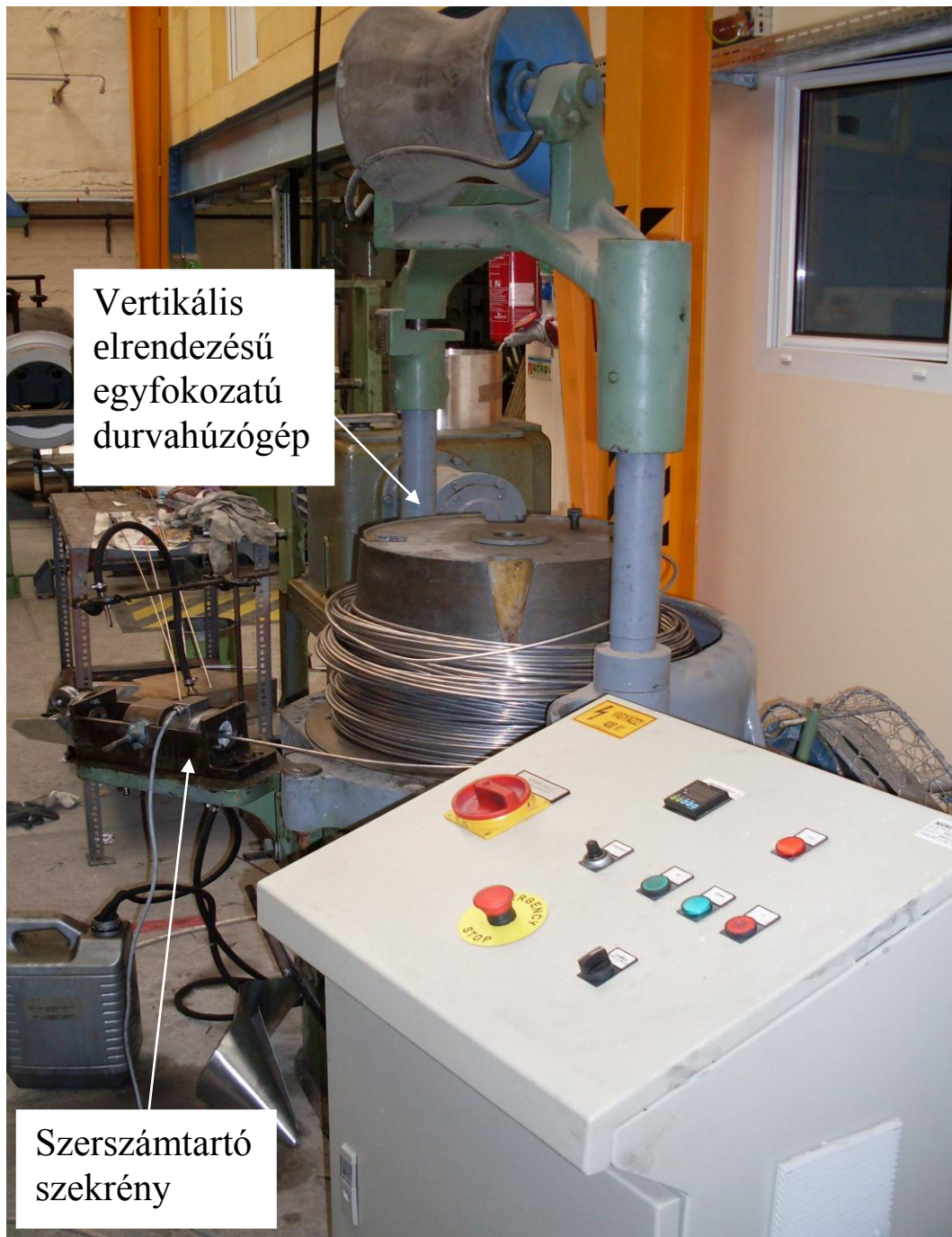
22. ábra. Az egyfokozatú húzó gép húzódobja, a diaboló, a szerszámtartó szekrény (mely a húzógyűrűt és a erőmérő cellát tartalmazza), valamint a berendezés irányító panelje.
