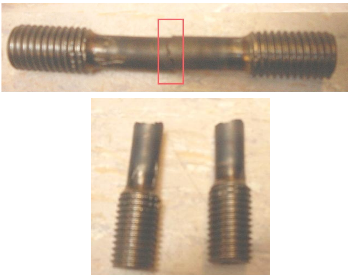
54. ábra. Eltört próbatest.
