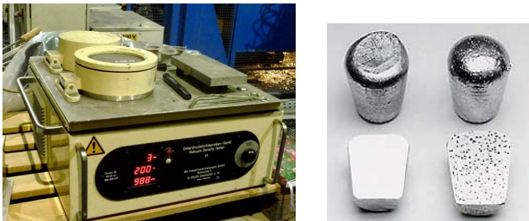
16. ábra. A sűrűségindex meghatározására szolgáló berendezés, illetve a levegőn és a vákuumban megszilárdult próbatestek metszeteikkel
