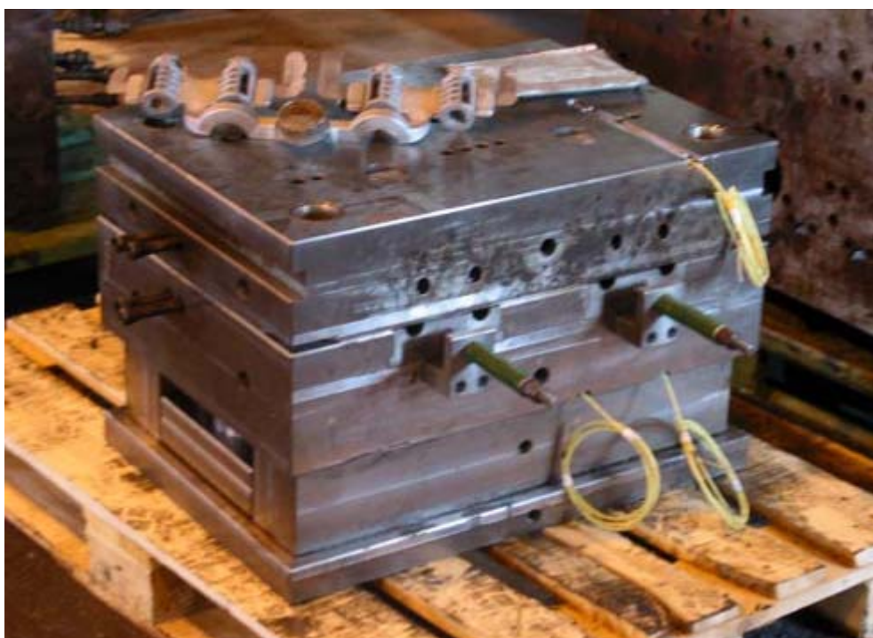
36. ábra Négyfészkös öntőszerszám a beépített hőelemekkel
