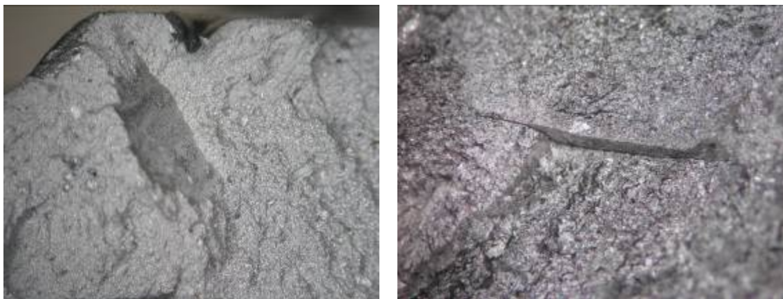
51. ábra. Oxidhártya mentén kialakuló törési felület
