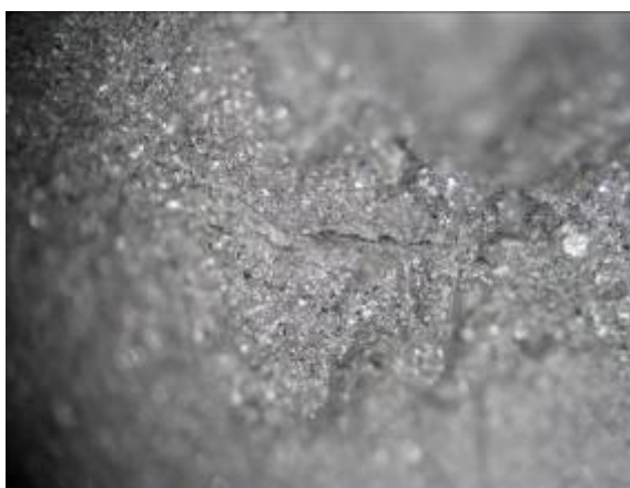
52. ábra. Törésfelület Repedés és oxidhártya mentén keletkezett szakadás
