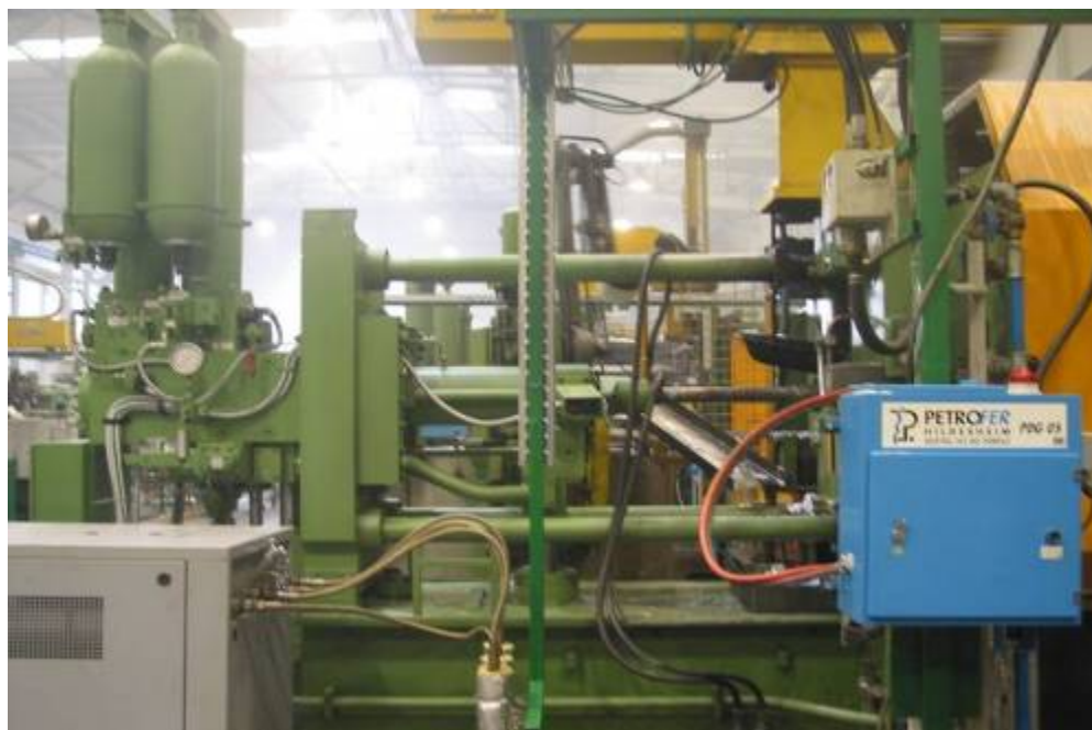
5. ábra. Hidegkamrás nyomásos öntőgép öntőegysége
