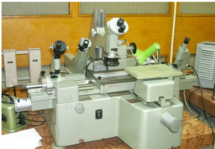
28. ábra: MF-1030 TH típusú egyetemes hossz mérőgép
