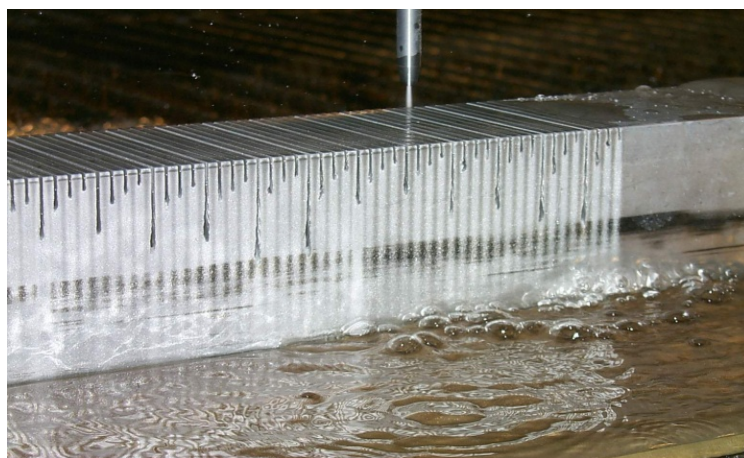
30. ábra: Bevágási kísérletek végzése AlMgSi0,5 alumíniumötvözeten
