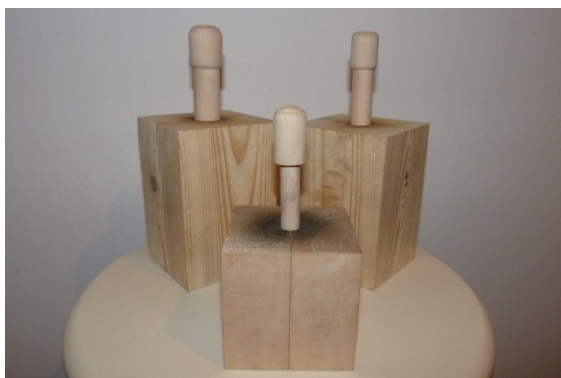
3.5. ábra - A próbatestek gyártásához használt formaszekrények
