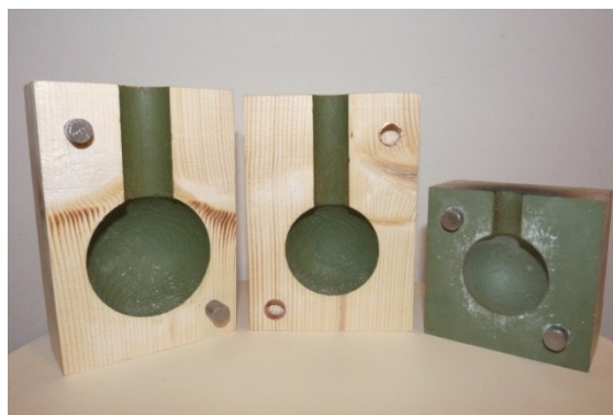
3.5. ábra - A próbatestek gyártásához használt formaszekrények
