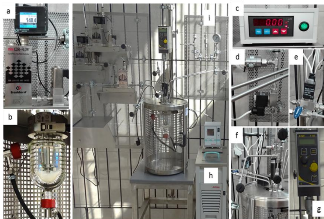
14. ábra: A kutatómunka során használt reaktorrendszer részei: a) áramlásszabályzó, b) reaktor, c) nyomásszabályzó, d), e) mágnes-szelepek f) mintavételező pont, g) keverő, h) hőmérséklet szabályzó
