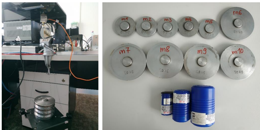
4.10. ábra: Erőmérés kalibrációja hitelesített mérő súlyokkal
