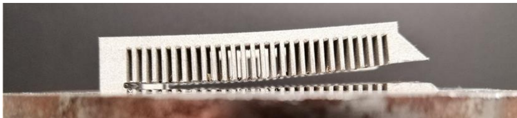
26. ábra, Maradó feszültség mérő próbatest tárgyasztaltól való vágása során kialakuló maradó alakváltozás
