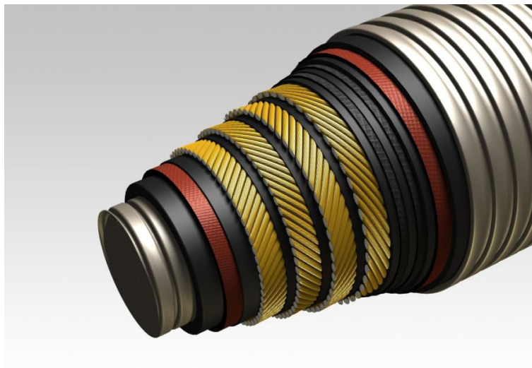
1. ábra Acélsodrony erősítésű olajipari termelő tömlő felépítése [1]
