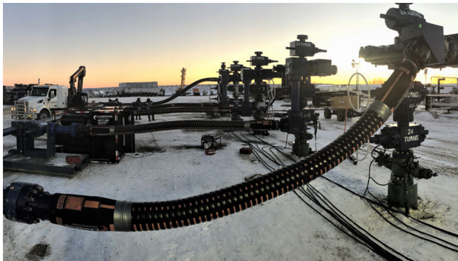
10. ábra Hidraulikus rétegrepesztő tömlők működés közben, a repesztő nyomást előállító szivattyú és az olajkútfejek között beszerelve (NA150, PN=1035 bar)
