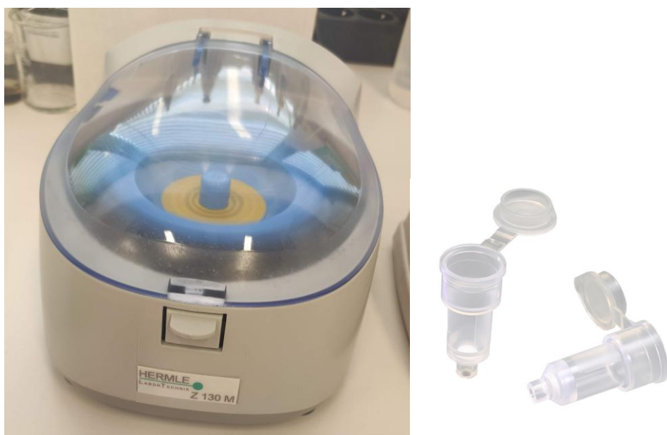
14. ábra Monospin amid oszlopon történő tisztítás centrifuga segítségével (jobbra)
