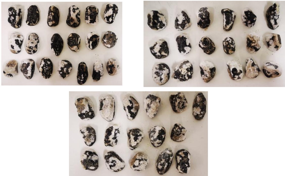
Bitumenes tapadóképesség meghatározása szemrevételezéssel
