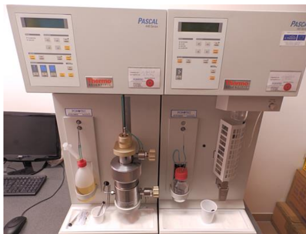
26. ábra .Kutatómunkámhoz alkalmazott Pascal 140 és Pascal 440 típusú higany-poroziméter
