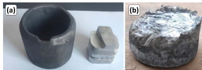
5M.2. ábra (a) O-kísérlet során használt grafittegely és betétanyag, valamint (b) a kísérlet során előállított minta
