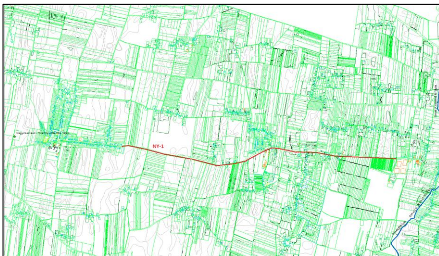
13. ábra Nagycserkeszt Nyíregyháza nyomóvezetékével összekötő szakasz [saját]
