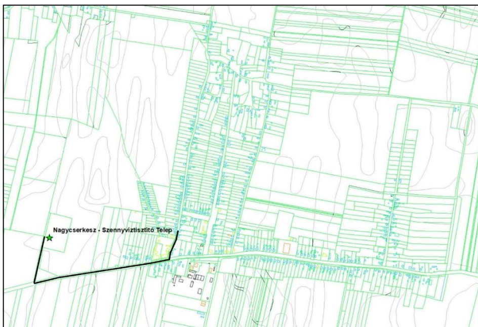
5. ábra Nagycserkesz szennyvízhálózat jelenleg meglévő szakasza [saját, ArcMap]
