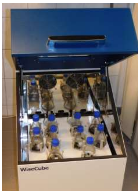
2.6. ábra: Az adszorpciós mérésekhez használt Wise Cube típusú rázógép
