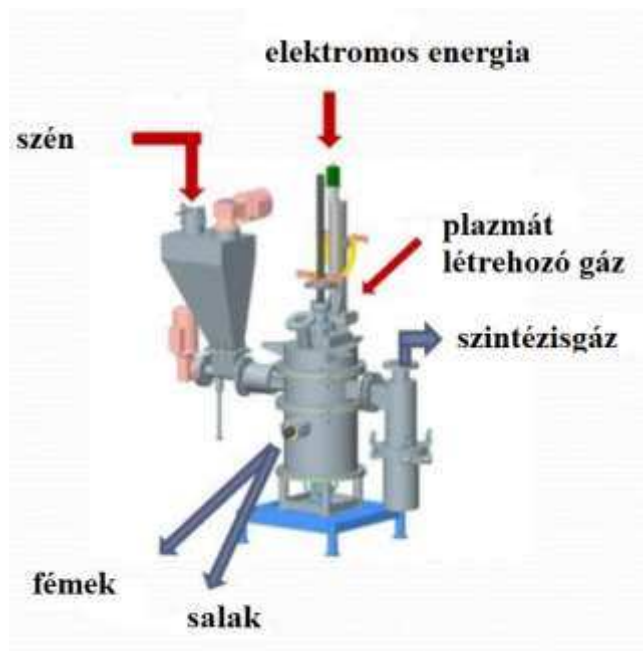
21. ábra: A plazmás szén-elgázosító berendezés részegységei (Lázár és Silvestri, 2014)
