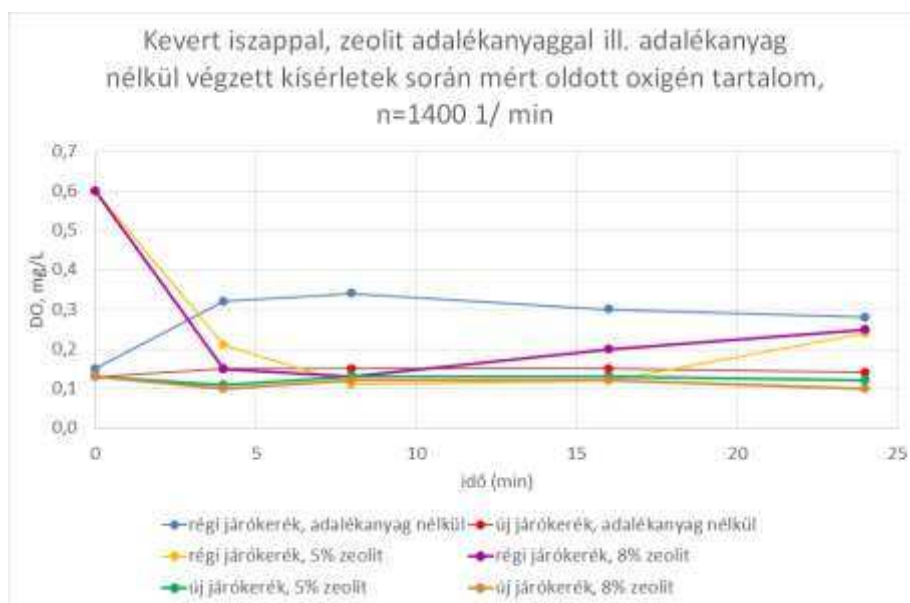
61. ábra: Az áramlástechnikai berendezéssel, zeolit adalékanyaggal, n=1400 1/min fordulatszámon elvégzett szennyvíziszap-stabilizációs kísérletek során mért oldott oxigéntartalom
