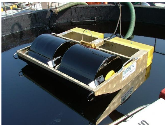
35. ábra Elastec MiniMax szeparátor (5 m 3 /h)
