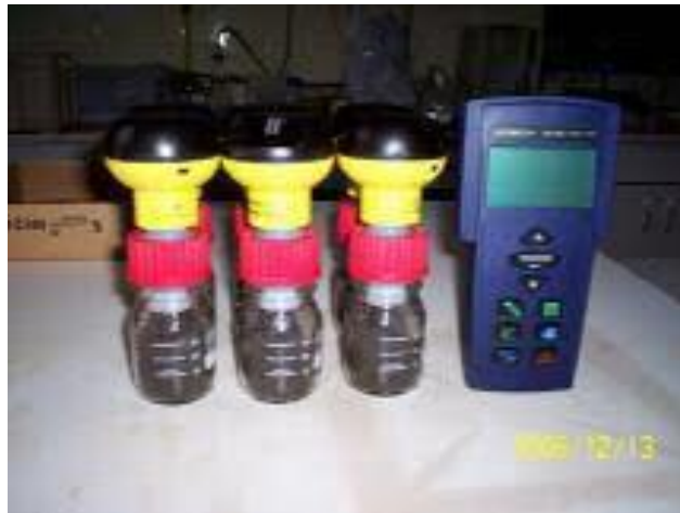
20. ábra Talajlégzés aktivitásának mérésére alkalmas edények
