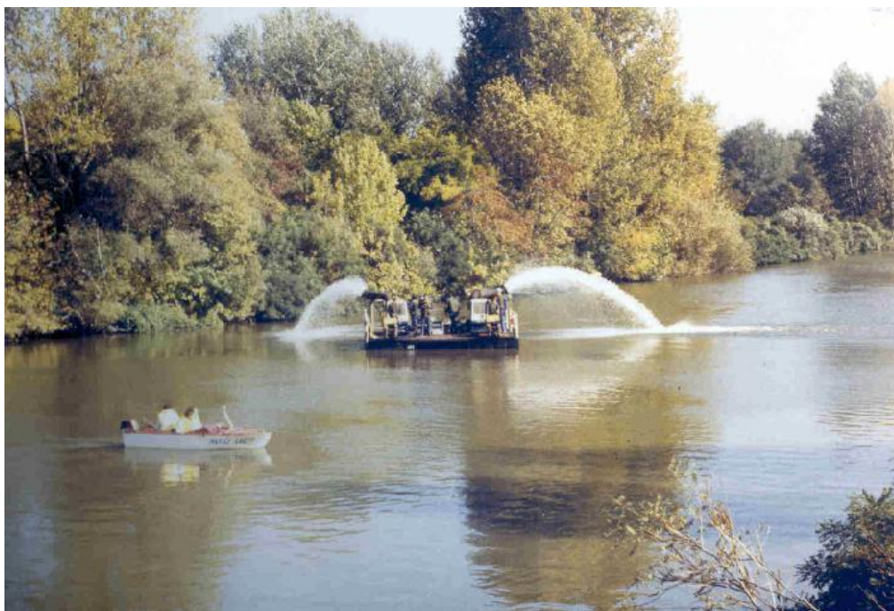
25. ábra Úszó pontontagra szerelt szivattyús levegőztető
