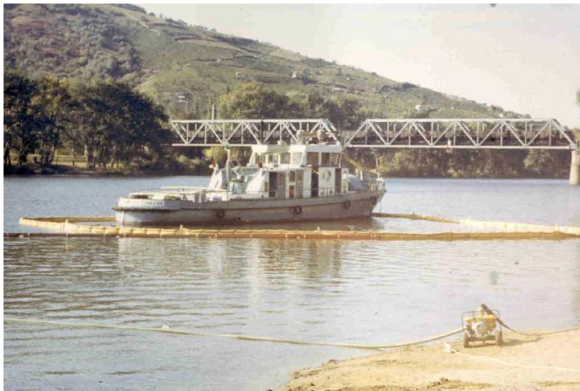
27. ábra Felfújható merülőfállal körbezárt kishajó az olaj szétterjedésének a megakadályozására.
