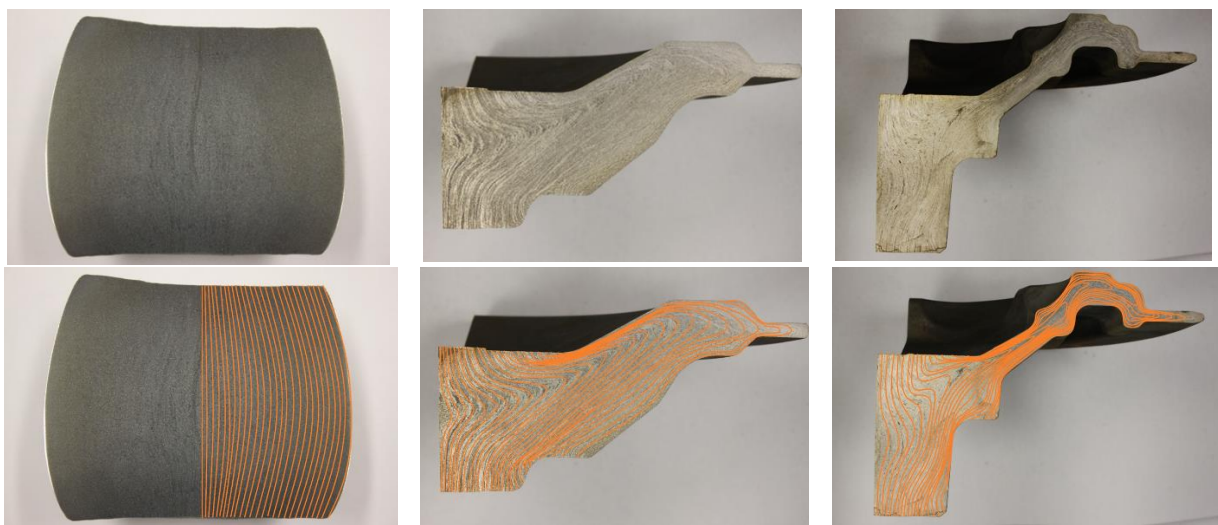
5. ábra. Zömített darab (bal felső), előkovács darab (középső fent) és készrekovácsolt darab (jobb felső) maratott képe és (alattuk) a maratott képekre felvitt szálfutási vonalak.
