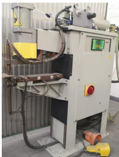
1. ábra. TECNA 8007 típusú ponthegeztő berendezés (AC, 50 Hz), TE 550 típusú vezérléssel.
