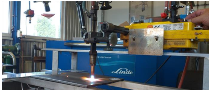
2. ábra. Lángergetési kísérlet a hőciklusok meghatározásához.
