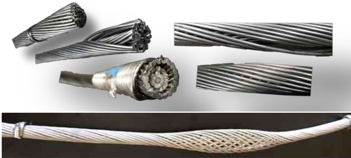
50. ábra Példák alumínium (aluminum stranded conductor - ASC) és ötvözött alumínium (alloyed aluminum stranded conductor - AASC) vezetéksodronyok jellemző sodratszerkezet megbomlása
