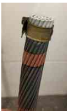
56. ábra Kémia maratással megtisztított sodrat vég és sodrat a CT kamrában
