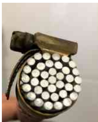
56. ábra Kémia maratással megtisztított sodrat vég és sodrat a CT kamrában
