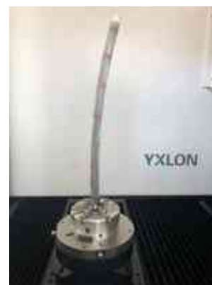
56. ábra Kémia maratással megtisztított sodrat vég és sodrat a CT kamrában
