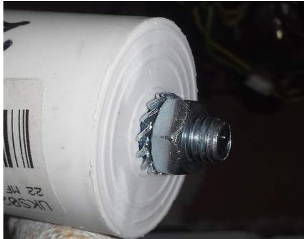
Ábra 13: Fogazott alátét DIN 6798 Használati példa: mosógép kondenzátor rögzítése
