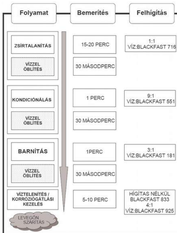
Ábra 21: Vegyi barnítás Blackfast gyártó eljárása szerint [14]
